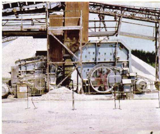
RT 150/100 típusú előtörő és RM 120/80 típusú utántörő egy kőbányában
